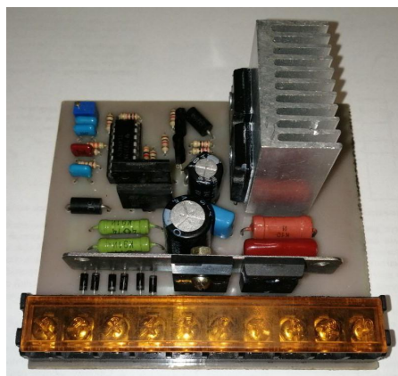
Рис. 7. Фото экспериментального образца АВР СГ
