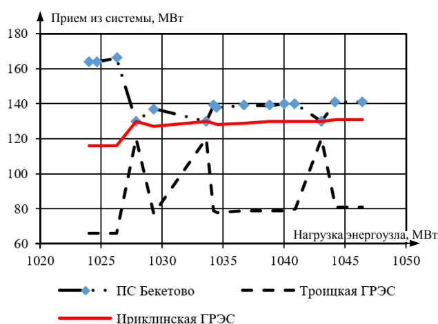
Рис. 4. Определение эквивалентной характеристики внешнего источника электроэнергии
