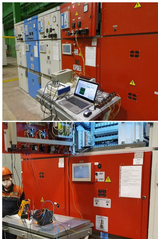
Рис. 1. Фотографии измерительного комплекса, применяемого при исследованиях на действующем оборудовании ЧерМК
