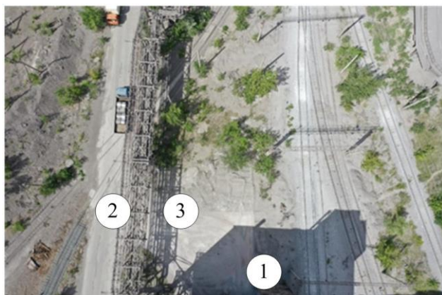
Рис. 5. Изображение фрагмента территории при образовании тени объектов: 1 – тень объекта, не входящего в локацию; 2 – объект, принадлежащий локации; 3 – тень объекта (2)
