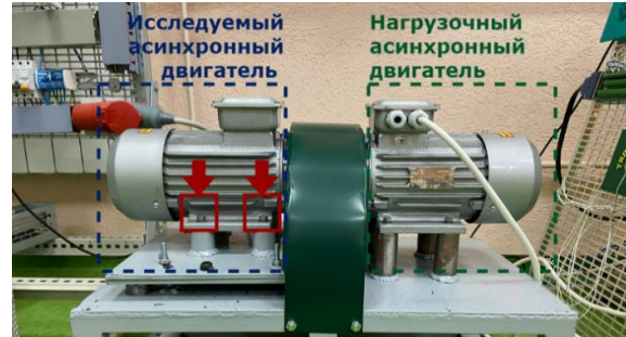
Рис. 2. Вид спарки исследуемого и нагрузочного АД с создаваемыми ослаблениями креплений
