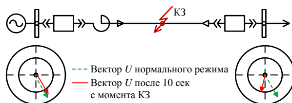
Рис. 1. Качественно показанное изменение векторов напряжения при коротком замыкании на линии
