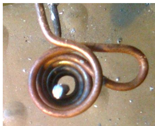
Рис. 5. Ускорение алюминиевого (1) и стального (2) тела по высоте индуктора с противовитком (а) и экспериментальный конический индуктор при нахождении в нем во взвешенном состоянии цилиндрического алюминиевого тела диаметром 5 мм (б)
