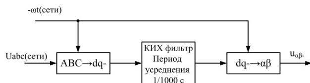
Рис. 3. Блок выделения составляющей напряжения обратной последовательности с помощью КИХ-фильтра
