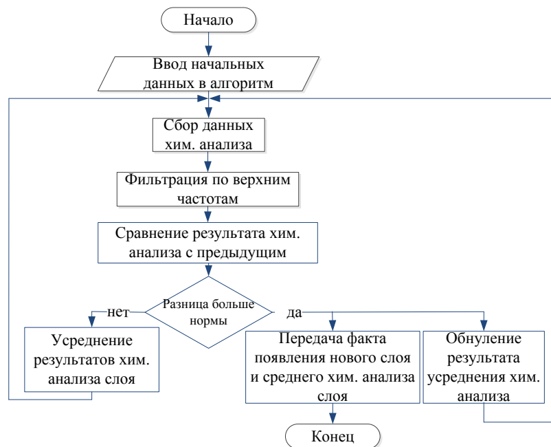
Рис. 2. Алгоритм работы подсистемы определения химического состава материала
