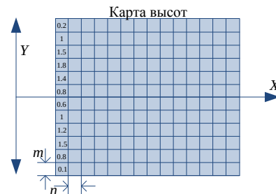
Рис. 5. Пояснения к алгоритму формирования полигональной сетки
