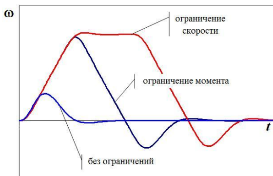
Рис. 2. Графики \omega(t) отработки скачка задания для больших, средних и малых перемещений
