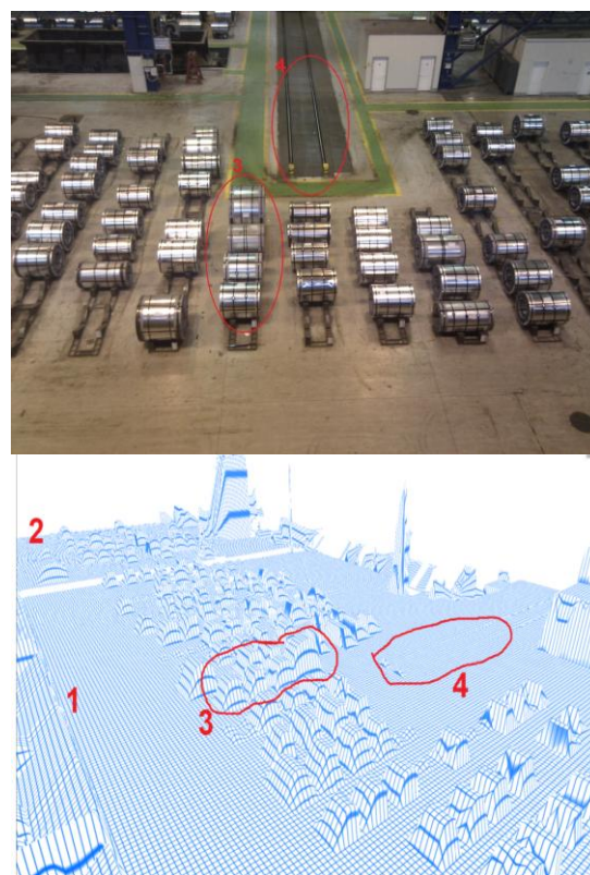
Рис. 4. Визуализация общей линии для загрузки и выгрузки материала со склада на грузовой транспорт на складе ЛПЦ-11 ОАО «ММК»
