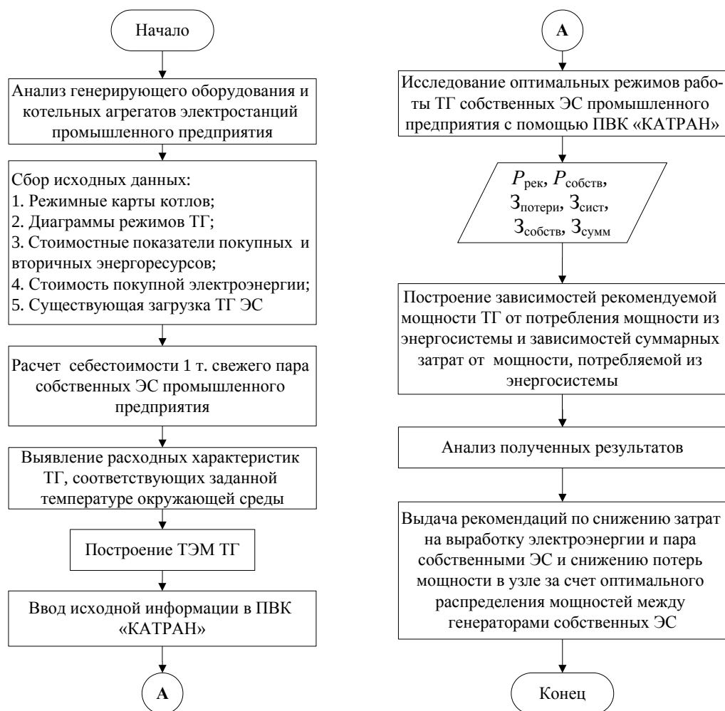
Рис. 2. Блок-схема методики оптимизации режимов электроснабжения промышленных предприятий с собственными ЭС
