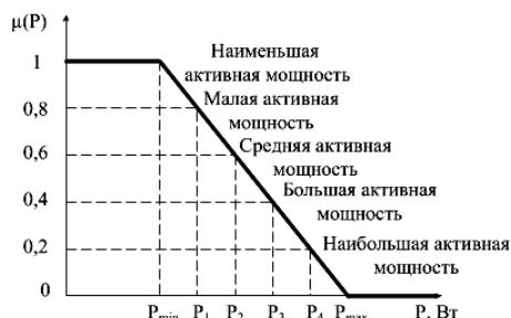
Рис. 1. К определению лингвистической переменной «активная мощность»
