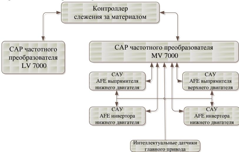
Рис. 1. Структурная схема системы слежения за материалом
