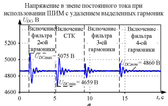
Рис. 6. Кривые напряжения в звене постоянного тока и действующих значений фазных токов, потребляемых АВ: a, б – ШИМ с фиксированными значениями углов переключений; в, г – ШИМ с удалением выделенных гармоник
