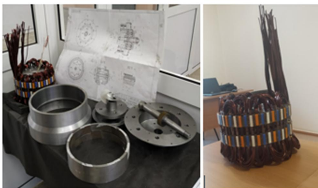
Рис. 8. Основные сборочные единицы генератора комбинированного возбуждения
