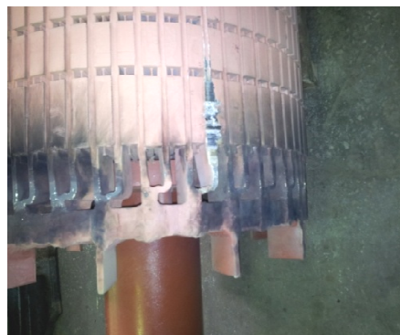
Рис. 1. Выход стержня ротора двигателя АДЧР-1600 из паза
