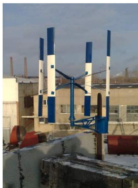
Рис. 6. Микро-ВЭУ с дублирующим солнечным модулем
