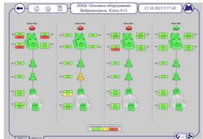
Рис. 5. Мнемосхема вибрационного состояния чистой группы клетей 8-11
