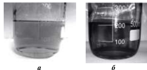
Рис. 2. Образцы для испытания: образец №1 – трансформаторное масло после года эксплуатации (а); образец №2 – трансформаторное масло после пяти лет эксплуатации (б)
