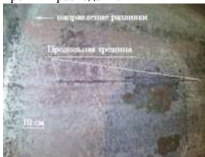
Рис. 1. Продольная трещина в теле отливаемой заготовки
