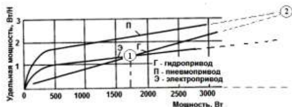
Рис. 3. Удельная мощность (отнесенная к весу) различных систем приводов в зависимости от абсолютной мощности
