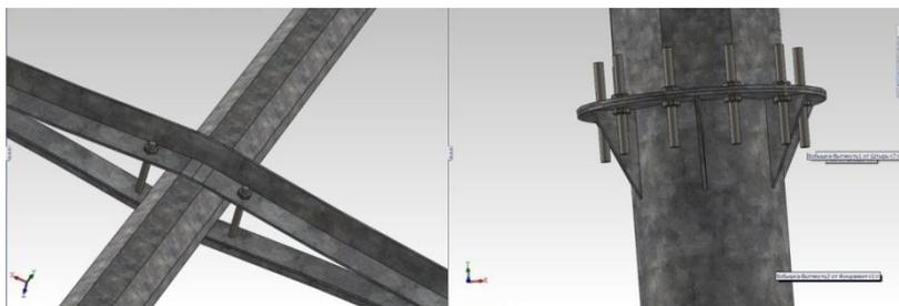
*Рис. 1. Фрагменты модели сборки опоры СМ10П*
